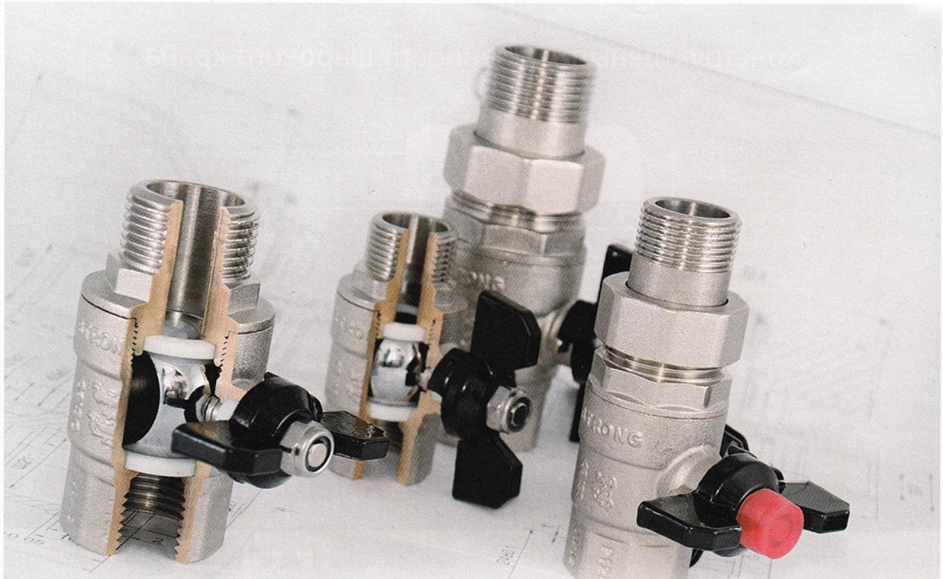
Как видно по маркировке, в этом сплаве свинец (Pb) составляет не более 2%, цинк (Zn) – 40%, а медь (Cu) – 58%. Такой сплав подходит для любого типа обработки и прессования. Что касается марки CuZn39Pb3 (CW614N), то она используется для производства шаров и штоков – внутренних элементов устройства, и не годится для изготовления изделий сложных форм.
