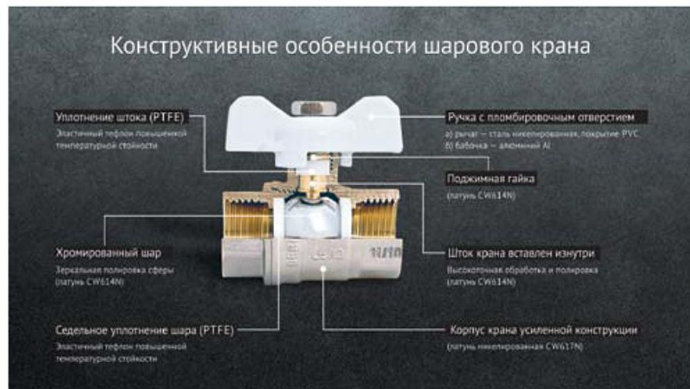
шаровых кранов из латуни марки CuZn40Pb2 (CW617N). Как видно по маркировке, в этом сплаве свинец (Pb) составляет не более 2%, цинк (Zn) – 40%, а медь (Cu) – 58%. Такой сплав подходит для любого типа обработки и прессования. Что касается марки CuZn39Pb3 (CW614N), то она используется для производства шаров и штоков – внутренних элементов устройства и не годится для изготовления изделий сложных форм.
