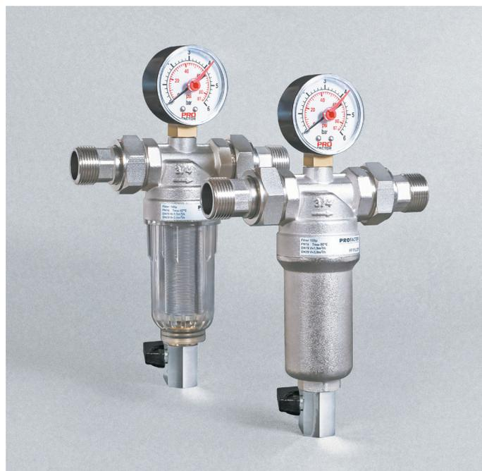
В конструкцию промывных фильтров **PROFACTOR®** заложено дополнительное преимущество. Их можно быстро и легко очистить без демонтажа и разборки устройства. Скопившаяся в фильтре грязь автоматически вымывается через сливной шаровый кран со штуцером, к которому присоединяется шланг, ведущий в канализацию. Достаточно повернуть ручку крана, и он выпустит всю грязь из фильтра, после чего кран нужно закрыть до следующей очистки.
